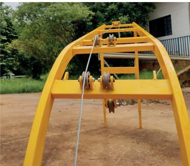
*Depois de travado, retire o cabo de aço da base fixadora e passe pelas polias laterais do Módulo Curvo, até a polia derivativa, retirando sua proteção e recolocando para sua segurança.*
