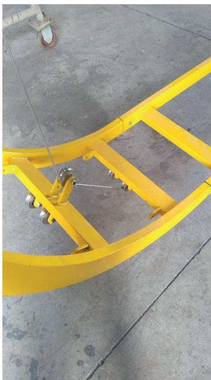
*Desenrole o cabo de aço até a primeira roldana do Módulo curvo (04), passe pela roldana de içamento que fica na parte traseira (côncava) do Módulo Curvo.*
