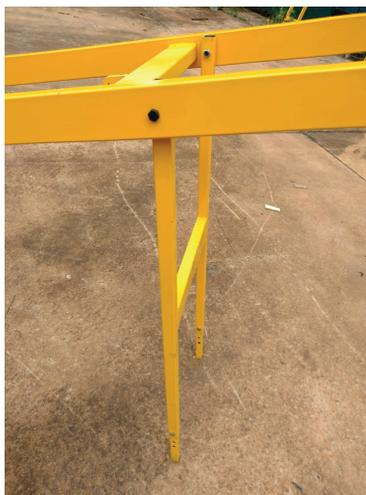
*O “H” (06) que estava fixado na base, agora é fixado no módulo final, pra apoiar no telhado, de modo que não force a ponta do elevador.*
