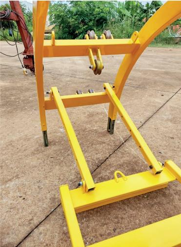
*Assim que for içado, deverão ser travados os braços da Base fixadora até o Módulo Curvo com os parafusos 3/8"X2" (12).*
