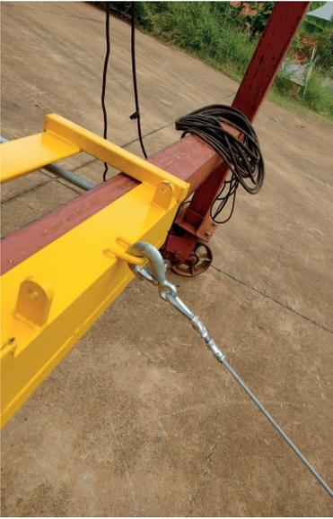
*Seguindo o cabo de aço até o olhal da base Fixadora (07), travando o gancho devidamente nesta peça. Feito todos esses passos, o elevador está pronto para ser içado.*
