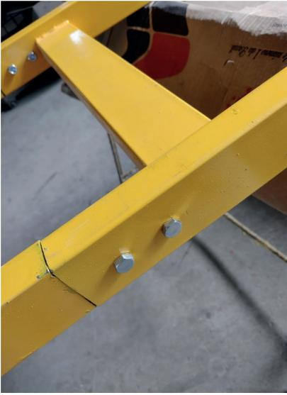
*Vai se acrescentando Módulos (02 e 03) até dar a medida da altura, lembrando que o Módulo Curvo (04) tem 0,5 metro a ser contados. Estes parafusos funcionam como pinos de trava, não necessitando de aperto excessivo.*
