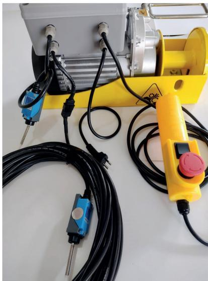
*Verifique a voltagem, conecte a extensão a rede elétrica, encaixe o plugue do sensor superior (10), que possui maior extensão, na Talha (08).*
