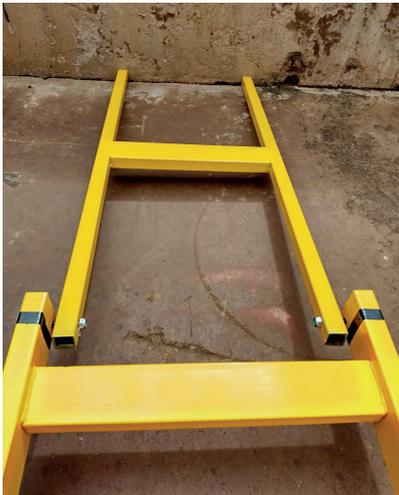
*Com a medida da base fixadora até o chão, comece a montagem propriamente dita. Colocamos o “H” (06) encostado onde será levantada a base do elevador (parede ou degrau) e utilizando parafusos 3/8”X2 1/2” (14), o fixamos ao Módulo Base (01).*
